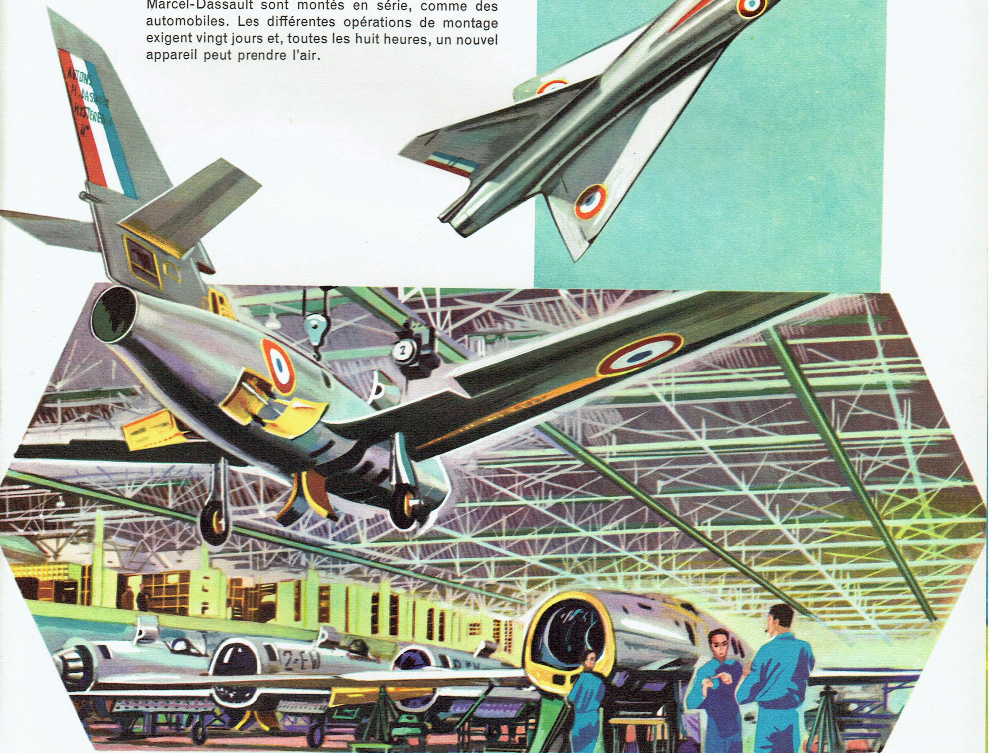
Atelier de montage de l'usine Marcel Dassault à Mérignac (Gironde), chaîne de montage des Mystère IV A et Mystère II Atar
